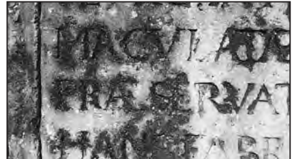
Figura 6 a-b. Detall de la crosta biogènica pulverulenta que altera el substrat i dificulta la lectura epigràfica
